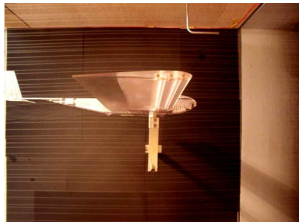
(b) スモークワイヤ法による気流傾角調査
