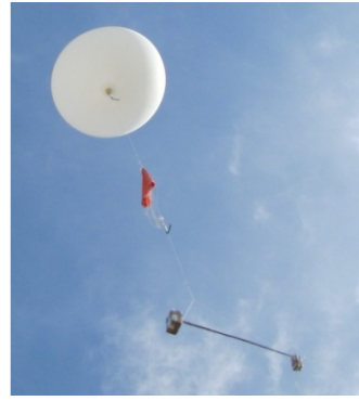
ゾンデを使った高高度実証試験
