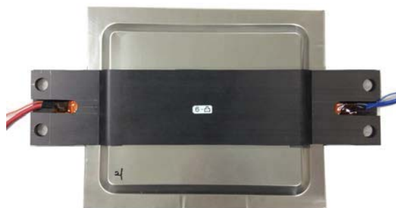
図9 CFRP板の簡易な拘束具を取り付けたSUSラミネートリチウムイオン電池
