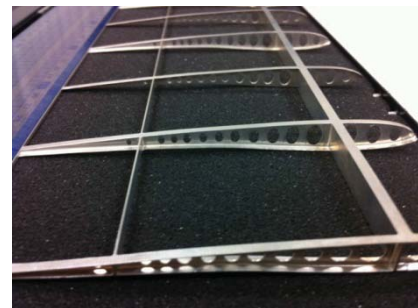
図3 マグネシウムの削りだしによる桁構造翼
