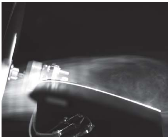
図8. レーザーライトシート法による流れ場
