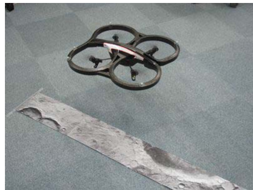
図 7 実験中の様子。図 3 で示した火星表面画像の上で AR.Drone を飛行させ, 位置推定を行った。
