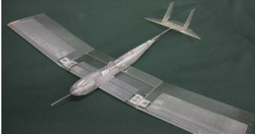
図 3.16 風洞試験模型(1/5 全機スケールモデル)
