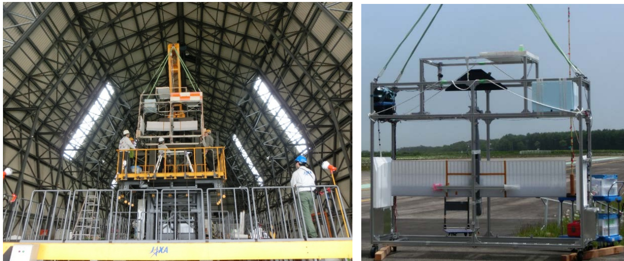
図 3.30 2013 年度の高高度飛行試験準備状況(左:放球前リハーサル, 右:2 次かみ合わせ試験)
