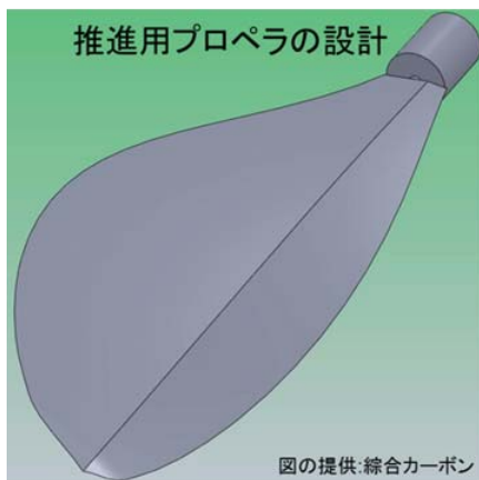
図6 火星飛行機用ブレードの設計例
